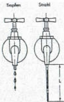
Bild 2: Wasserverluste tropfender Armaturen:
